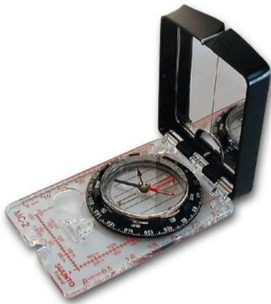
Lo specchietto montato sulla bussola a lato raffigurata è ad esempio utile per poter definire l'azimuth di un obiettivo, “guardando” attraverso lo specchio l'oggetto-bersaglio e leggendo, grazie allo specchietto, i gradi di azimuth (tale procedura prende il nome di **collimazione**).
