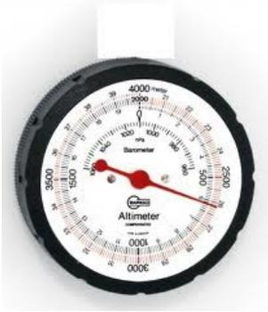
L'**altimetro** è uno strumento che misura la pressione atmosferica. Al salire della quota la pressione atmosferica diminuisce, perché minore è il "peso" dell'aria sopra di noi. L'altimetro è così in grado di raffigurare questa pressione in una scala graduata espressa (in Italia) in metri.
