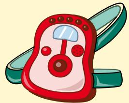
**ARTVA:** significa Apparecchio di ricerca travolti in valanga, è un apparecchio che permette di essere localizzati sotto una valanga o di cercare un sepolto in valanga. Ricordati di indossarlo il più vicino possibile al corpo, sotto uno o due strati di abbigliamento. Controlla il suo funzionamento prima di iniziare l’attività.
